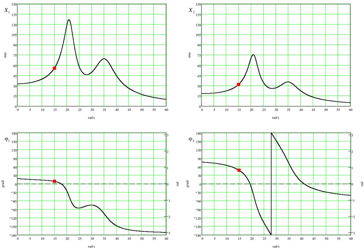
Figura 5: Ampiezze di oscillazione  $X_1$  e  $X_2$  e corrispondenti sfasamenti  $\varphi_1$  e  $\varphi_2$  in funzione della pulsazione  $\Omega$  (curve di risposta in frequenza). I riquadri indicano il punto di funzionamento del sistema vibrante per la pulsazione assegnata  $\Omega = 15$  rad/s.
