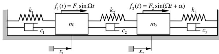
Figura 4: Sistema a due gradi di libertà smorzato con forzanti armoniche sfasate.
