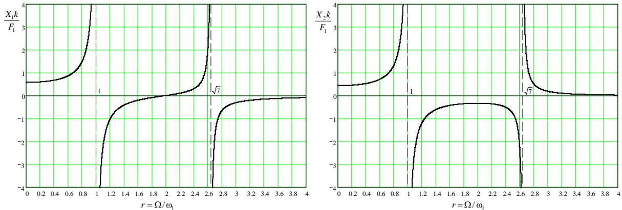
Figura 3: Ampiezze di oscillazione  $X_1$  e  $X_2$  in funzione del parametro  $r = \Omega/\omega_1$  (curve di risposta in frequenza).
