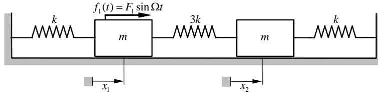
Figura 2: Sistema a due gradi di libertà non smorzato con forzante armonica.
