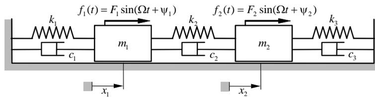
Figura 1: Sistema a due gradi di libertà con forzanti sinusoidali.
