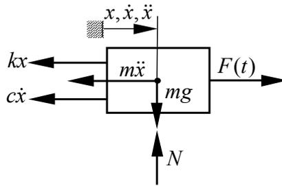
Figura 2: Diagramma di corpo libero per il sistema di Figura 1.
