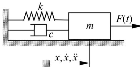
Figura 1: Sistema vibrante elementare ad un grado di libertà.
